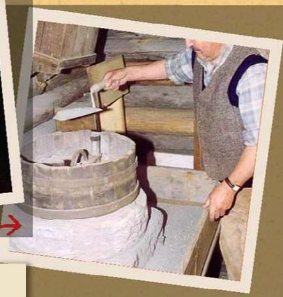
**2** Le minerai est ensuite chargé dans le broyeur et finement broyé jusqu'à ce qu'il devienne d'une consistance presque impalpable.
